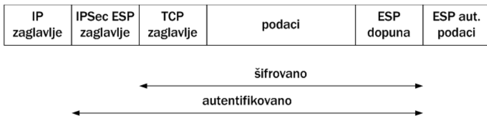
Slika 4.9. ESP u transportnom režimu rada
